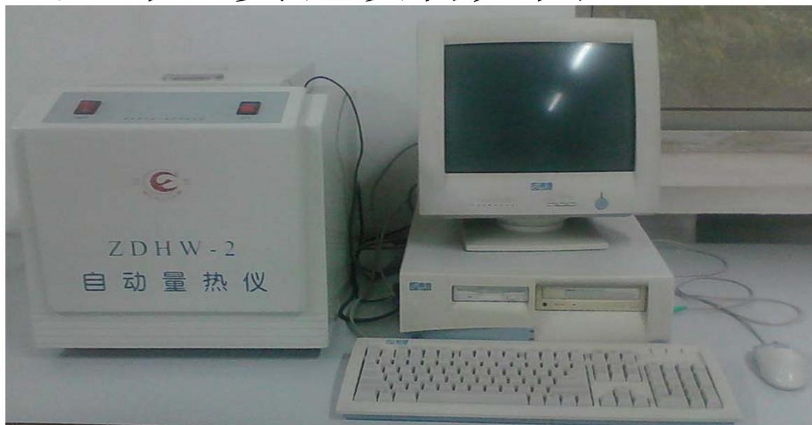
图1自动量热仪设备实物图
